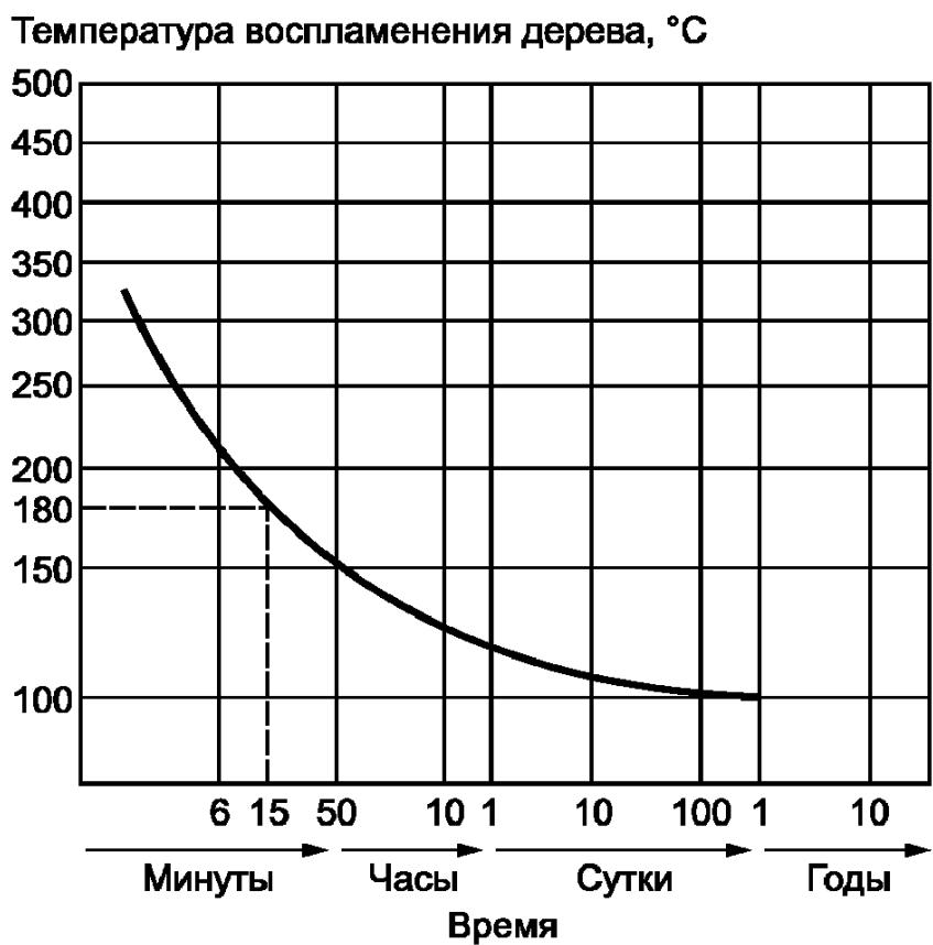
Рисунок 27. Температура воспламенения дерева в функции времени
