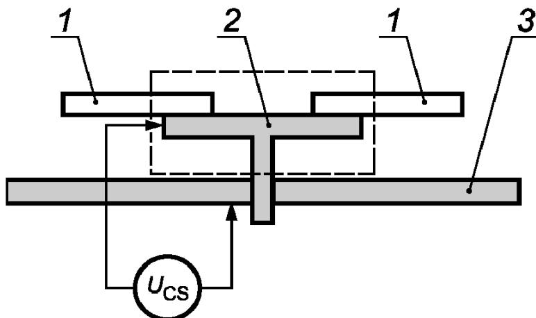
1 - провод; 2 - контактный зажим; 3 - опорная пластина;
