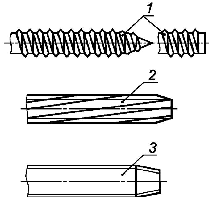
1 - винт саморежущий с острым или плоским концом;
