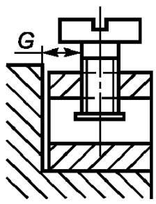
D - диаметр гнезда жилы провода, G - расстояние между винтом и концом полностью введенной в зажим жилы
