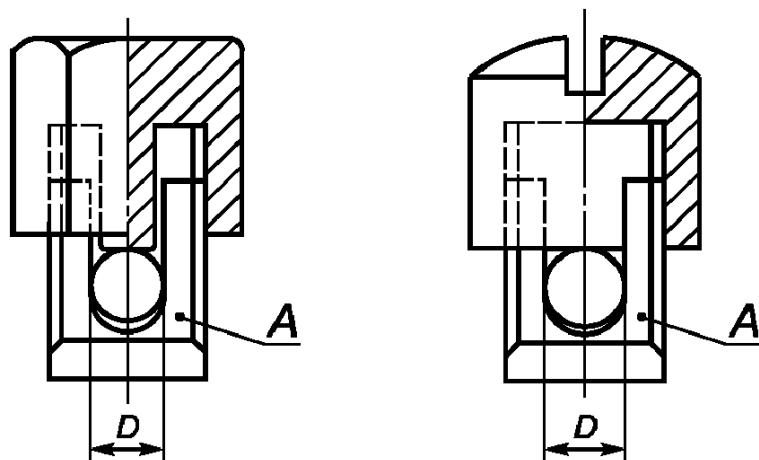
A - опорная деталь; D - диаметр
