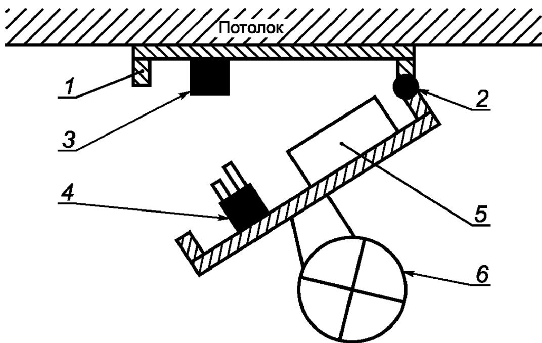
1 - основание светильника; 2 - шарнирное соединение (УУЛ и основание светильника легко снимаются); 3 - штепсельная соединительная розетка (для подключения к сети питания);
