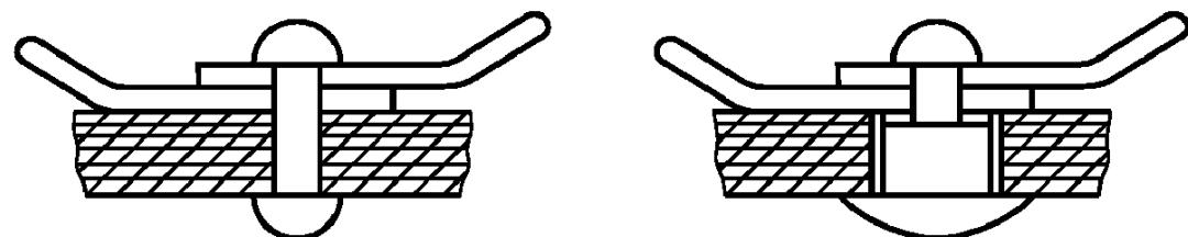
Рисунок 17. Конструкция электрических соединений
