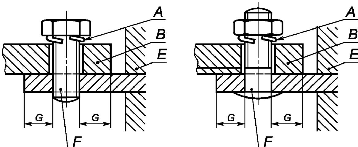
A - устройство защиты от самоотвинчивания; B - кабельный наконечник или плоский вывод; E - опорная деталь; F - шпилька; G - расстояние между краем отверстия и боковой стороной кабельного наконечника или плоского вывода
