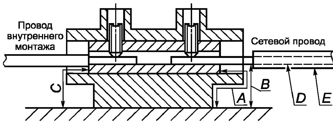
А - пути утечки; В - воздушный зазор (сетевой провод); С - воздушный зазор (провод внутреннего монтажа); D - проводник, Е - изоляция
