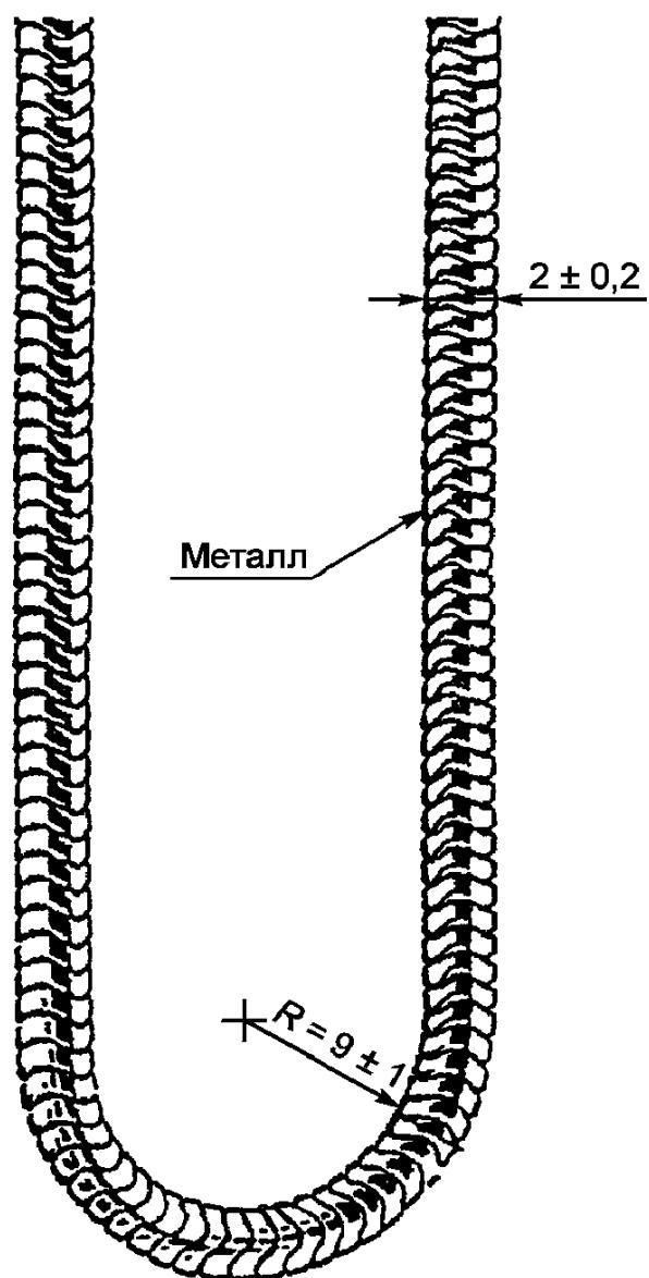
Рисунок 29. Цепь для испытаний
