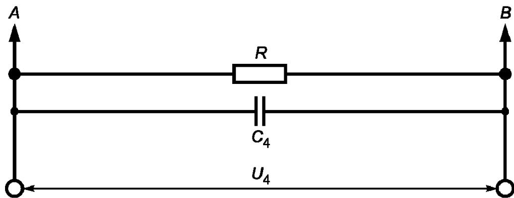
$$I_{\text{защитный}} = U_4 / R ; \quad R = 150 \text{ Ом} ; \quad C_4 = 1,5 \text{ мкФ}$$
